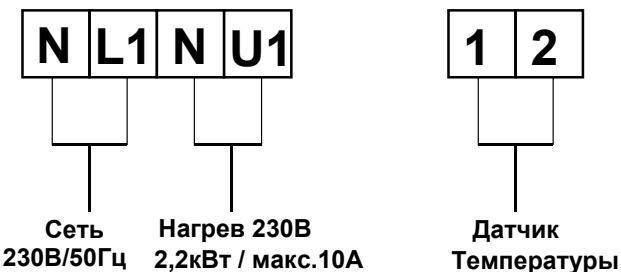
Кабель датчика температуры можно удлинить экранированным проводом (2x0,75мм<sup>2</sup>) до 10 м. Экран присоединить к клемме 1. Непременно прокладывайте проводку водоустойчиво. Избегать прокладку кабеля датчика в близи с силовыми кабелями из-за возможных наводящихся помех.
