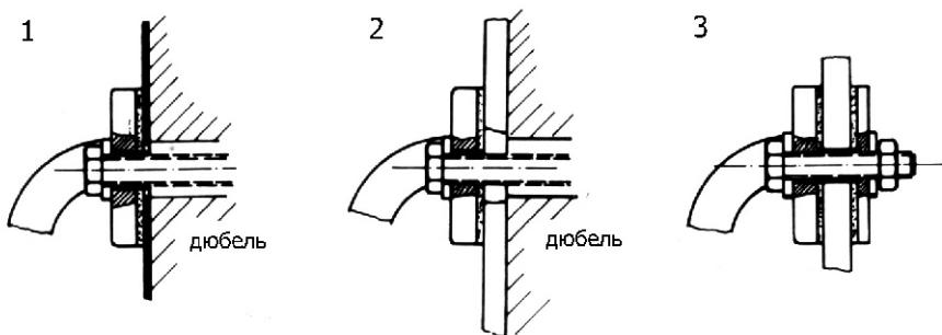
Разрез стены бассейна для монтажа противотока
