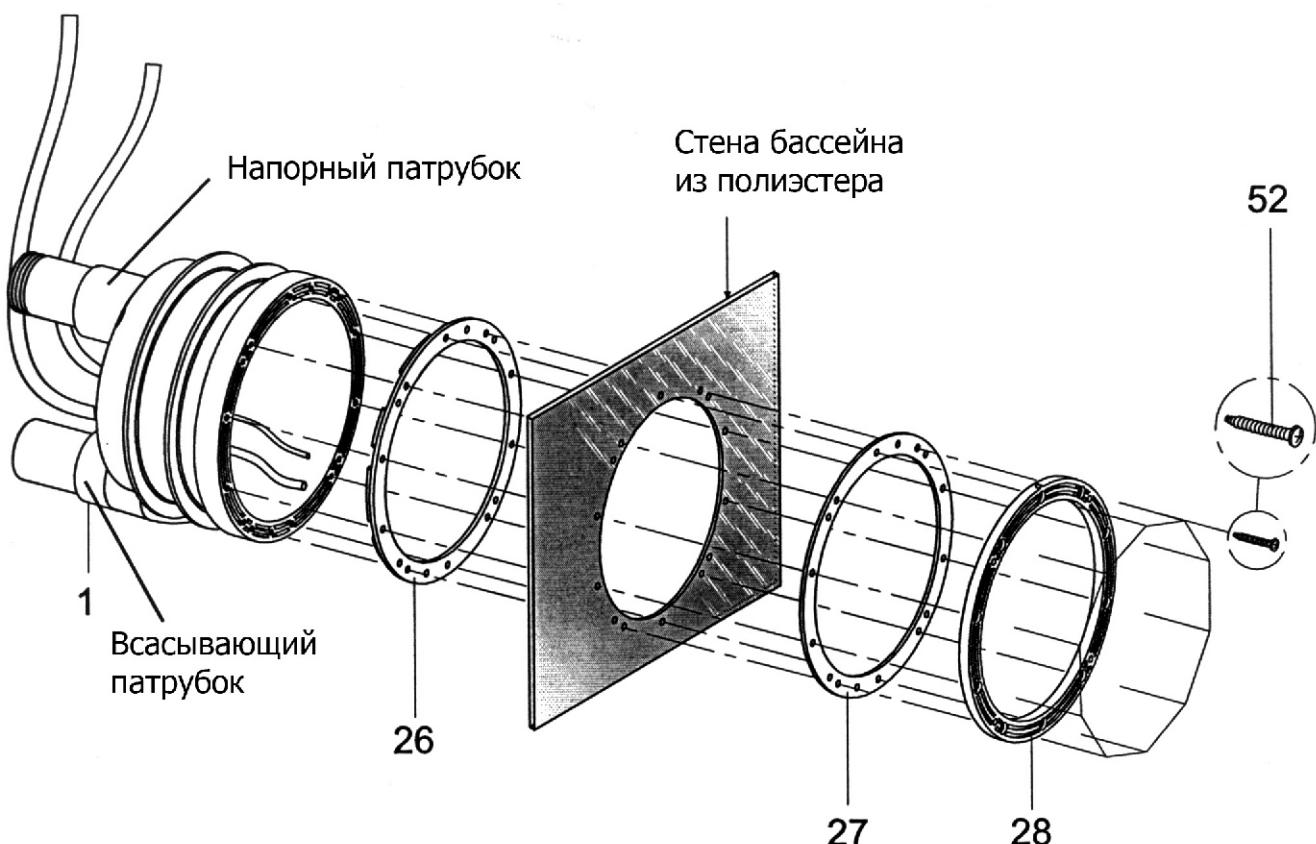
На встроенный корпус (1) установить уплотнение (26), вдавить его и прижать к обратной стороне стенки бассейна.
