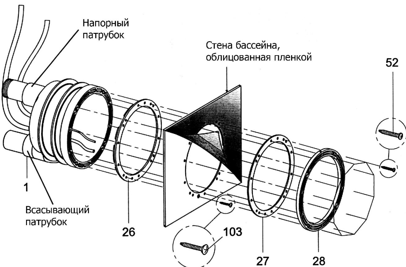
На встроенный корпус (1) установить уплотнение (26), вдавить его и прижать к обратной стороне стенки бассейна.
