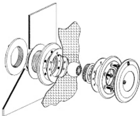
**Установка на бассейн, снабженный нарезной трубкой в стенке бассейна и гидроизоляционной пленкой**
