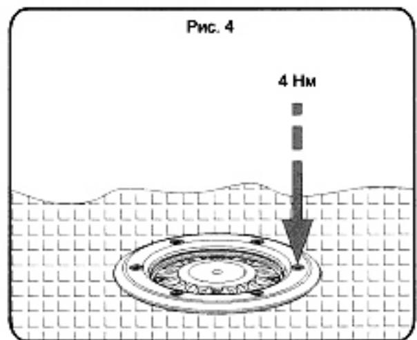
Установка на бассейн из бетона
