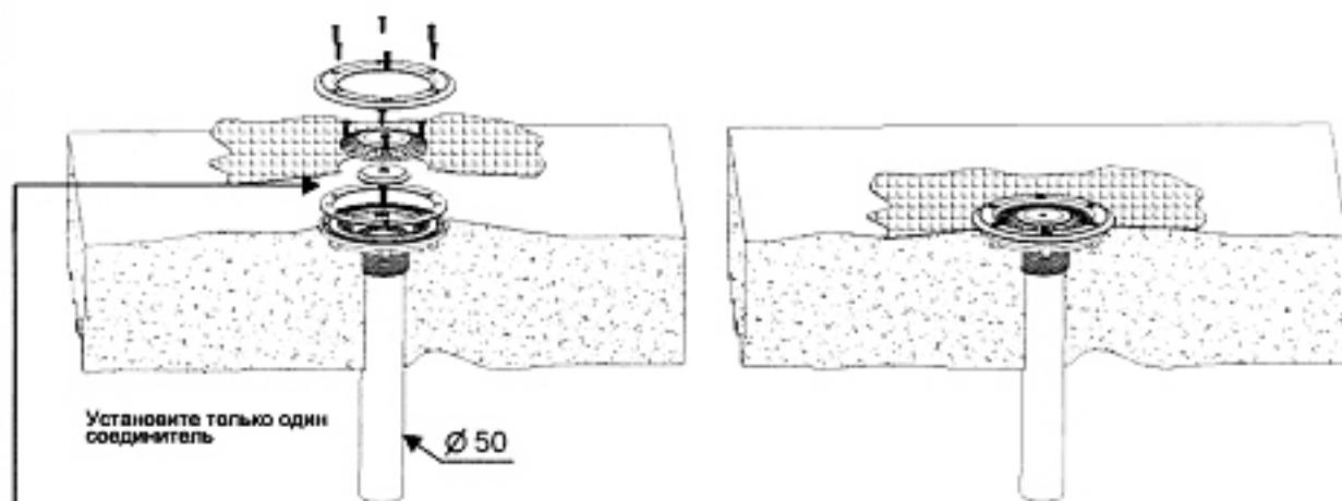
Установка на сборный бассейн, снабженный гидроизоляционной пленкой
