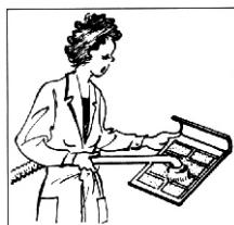
Очистите фильтр с помощью пылесоса или промойте его водой. Перед установкой фильтра на место, дайте ему высохнуть.
