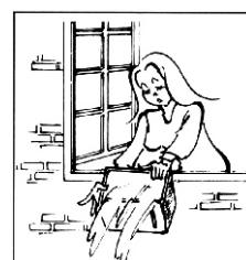
**4.6.** Опорожните водосборный резервуар перед транспортировкой осушителя, чтобы избежать его перелива.
