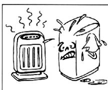
**4.5.** Не устанавливайте комнатный осушитель вблизи мощных обогревательных приборов и в местах, где прибор будет подвергаться прямому солнечному излучению. Вследствие нарушения этого указания возможны деформация и изменение цвета комнатного осушителя.
